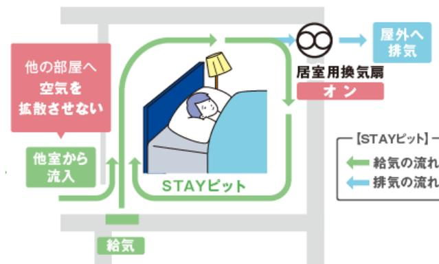
換気扇を運転すると、STAYピットの空気をそのまま外に排気できるので、万が一のときに、他の部屋への拡散の不安を軽減します。
