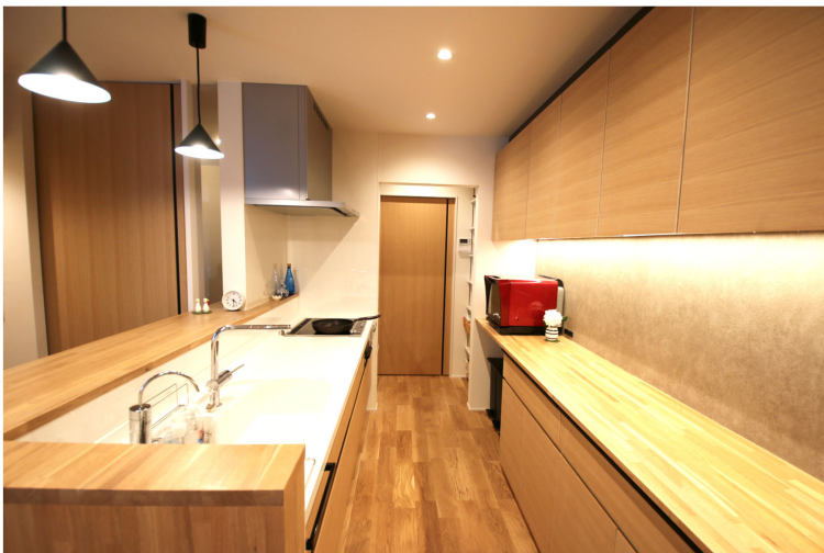
IHヒーターと同時給排気型のレンジフード
