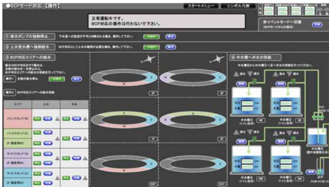
中央監視の災害時対応画面
