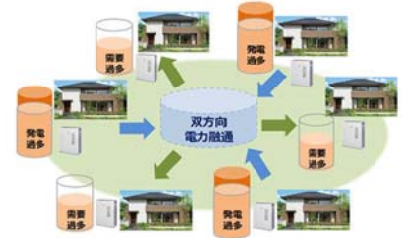
(図2) 蓄電池制御による電力融通イメージ
