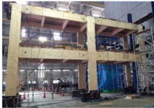
集成材半剛節フレーム架構の性能評価実験
