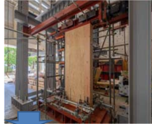
集成材・接着パネル併用構造フレーム性能評価要素実験
