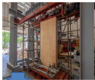
接着ロッドの本数と配置のパラメトリックスタディ
