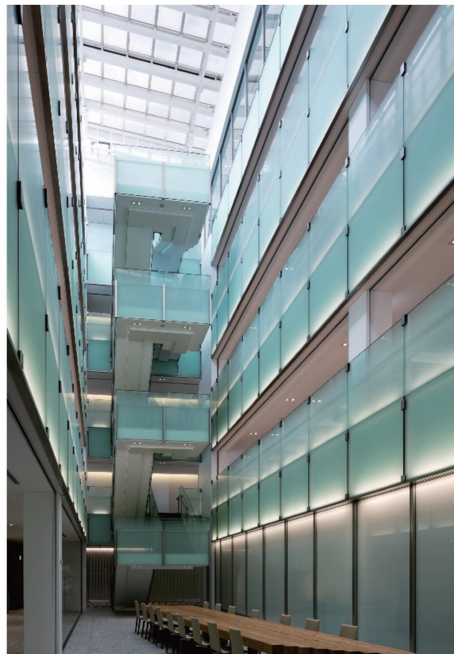
コミュニケーションを誘発する吹抜空間。自然換気・自然採光の経路としても機能する
